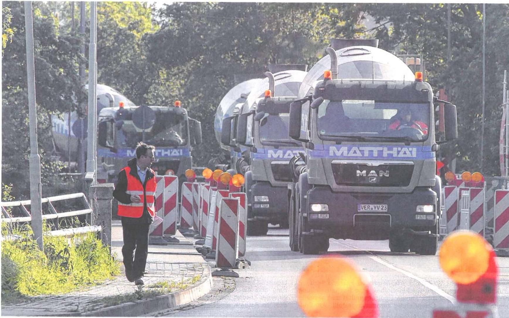
Schwere Brocken auf der Verdener Nordbrücke: Beim Belastungstest wurden vier Betonmischer mit jeweils 30 Tonnen Gewicht über die marode Allerquerung gefahren. An bestimmten Stellen maßen Sensoren die Verformungen der Konstruktion. Ingenieure berechnen aus diesen Daten den Zustand der Brücke. Die Ergebnisse sollen in die Planungen zur Sanierung einfließen.
