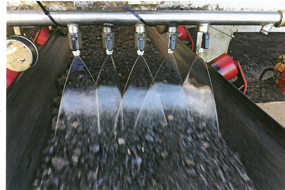
Das Asphaltgranulat wird mit Sylvaroad betropft, bevor es in den Mischer gelangt.
