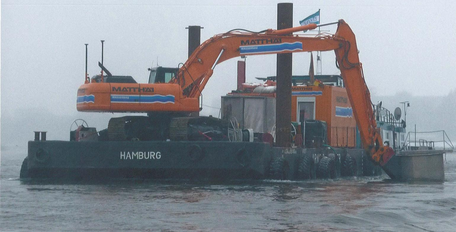
gen ein. Ein zuverlässiges und modulares System, das ich flexibel einsetzen kann, ob als Referenzstation auf der Baustelle oder wie hier im Wasserbau auf der Maschine.» Auf den Baggern sind je zwei Leica MNA1202 GG Antennen und Leica PowerBox GNSS-Empfänger installiert, die die Positionen per Satellit empfangen und an die Steuerung übermitteln.
